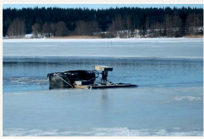
Tottijärvellä vettä on hapetettu talvisin jo vuosien ajan. Talvella 2009 hapettimen lähellä oli laaja sula alue ja hapetin oli sekoittanut vesimassan lähes tasalämpöiseksi. Hapetuksen ansiosta happitilanne oli hyvä pohjaan saakka. Kuva: Reijo Oravainen
