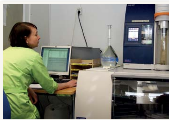
Nykykaikaista Kjeldahl-typen määrittystä tekemässä laborantti Jaana Ekdahl. Kuva: Marko Nieminen
