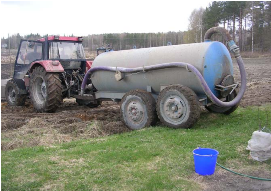
Kuva 2. Maataloudessa käytettävä imupainevaunu soveltuu hyvin kalkkistabiloinnin suorittamiseen
