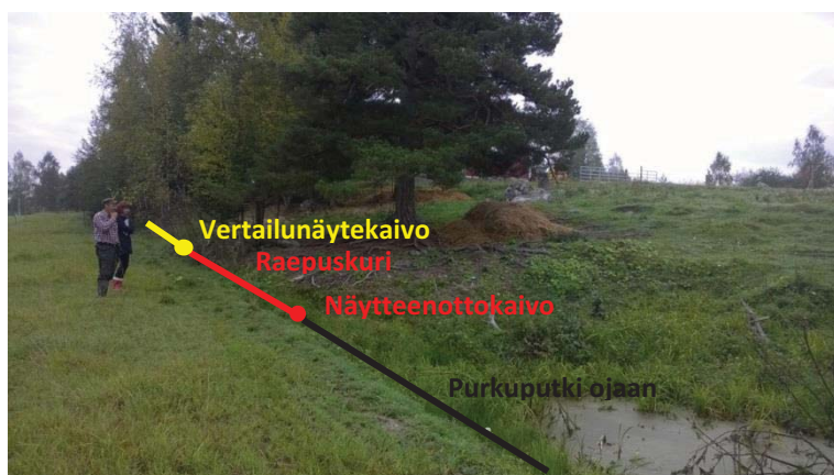
Kuva 3.15. Syyskuussa 2014 rakennetun raepuskurin tutkimusjärjestelyt.
