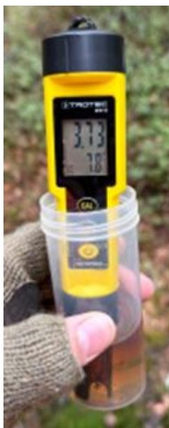
Kuva 23. Kenttämittarilla maastossa saatu pH-lukema 3,73 osoittaa miten hapanta turvemailta suotautuva vesi voi olla. Oikeanpuoleisessa kuvassa otetaan näytettä sammaloituneeseen ojaan asennetun v-padon alapuolisesta vedestä. Kuva: Kaisa Kähkövaara, KVVY Yhdistys
