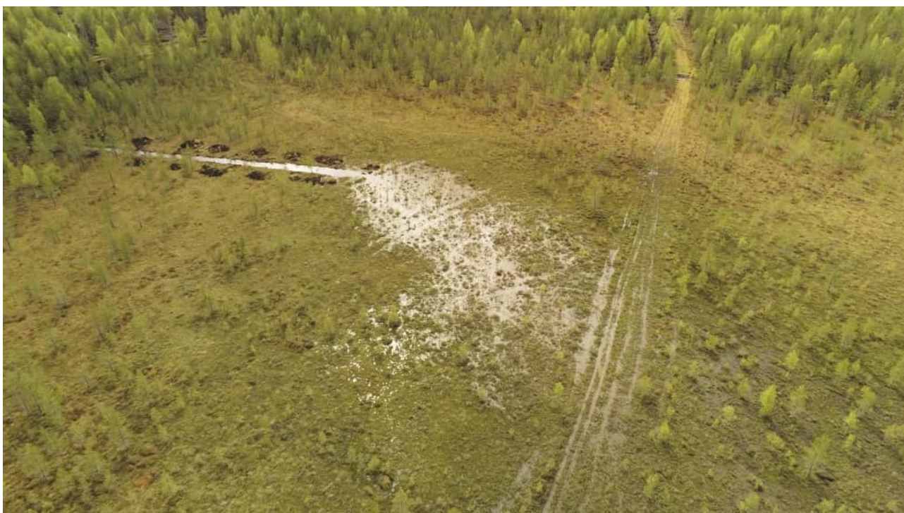
Kuva 11. Vesien suuntaaminen johto-ojan avulla suolle. Kuva Jani Antila, Tapio.
