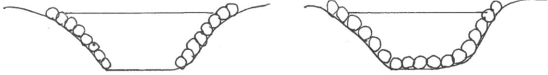
Kuva 8. Uoman reunojen eroosiosuojausmenetelmät. Piirros Elina Nystedt, KVVY Yhdistys.
