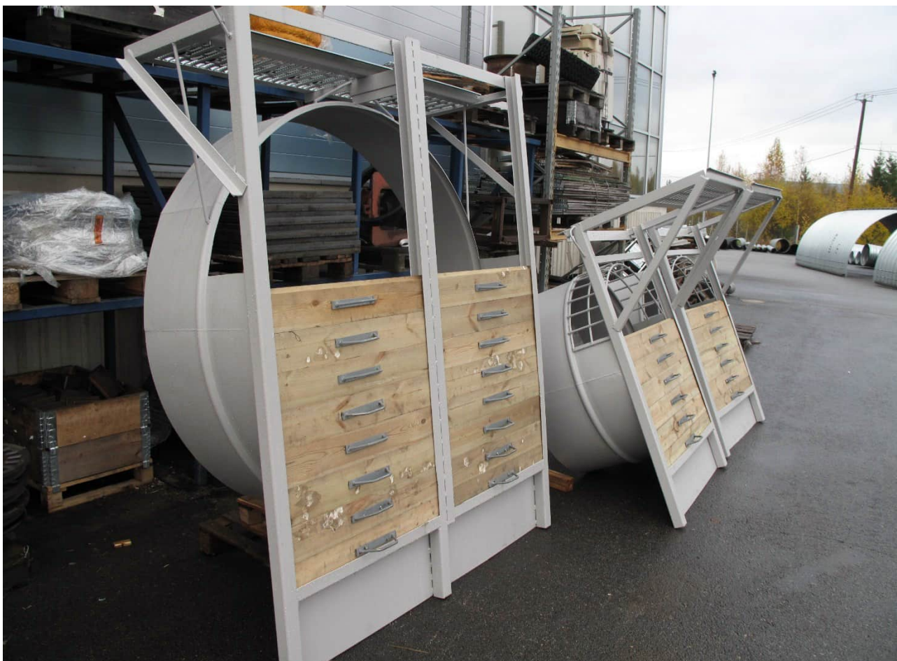
Kuva 4. Lankuilla mukautettavan moduulin avulla pohjapadon yläpuolista vesipintaa on mahdollista säätää. Moduuleja on saatavilla eri valmistajilta ja eri kokoihin rumpuputkiin sopivia. Kuva ViaCon.
